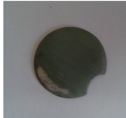
b) CGO sintetizado sem dopagem sinterizado a 1500 °C
