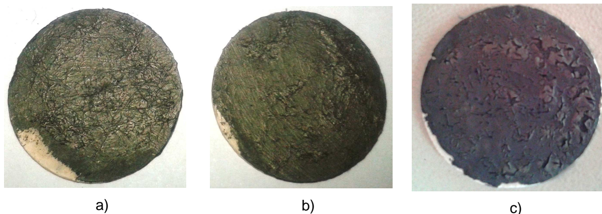
Figura 5.21: Fotografias de células-teste nas quais se depositou por pincel catodos coletores de corrente com formador de poros de: a) algodão b) nanofibra de carbono c) fragmentos de fibra capilar.
