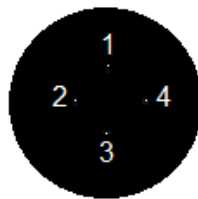
Figura 3.2: Representação da superfície de uma amostra a ser caracterizada por VdP.
