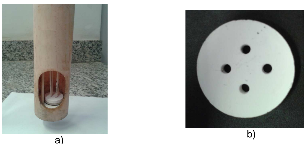
Figura 4.3: a) Célula de medição de resistividades de camada fina em alta temperatura empregando o método van der Pauw (VdP). b) Peça cerâmica utilizada como guia para os eletrodos.
