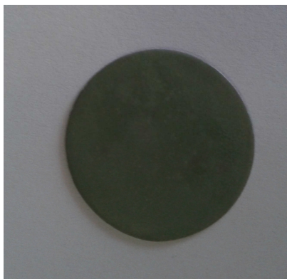
d) CGO sintetizado dopado com 1% de Zn sinterizado a 1500 °C
