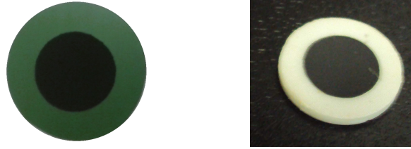
Figura 2.3: Células unitárias tipo botão sustentadas pelo anodo (à esquerda) e pelo eletrólito (à direita).
