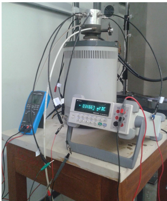
Figura 4.5: Aparato utilizado para as medidas de quatro pontas não colineares e cinco pontas colineares.
