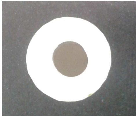
a) CGO comercial sem dopagem sinterizado a 1200 °C
