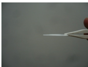
Figura 29: Filtro misto de celulose após o uso filtração utilizando água como solvente.
