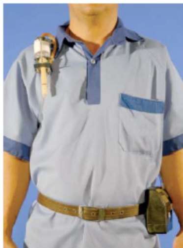
Figura 6: Montagem dos equipamentos de amostragem na zona de respiração conforme NHO 08. Figura reproduzida da referência [21].
