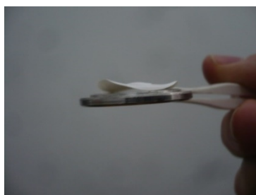
Figura 28: Filtro de misto de celulose deformado devido ao uso de 2-propanol sobre o suporte de leitura do difratômetro de Raios X.
