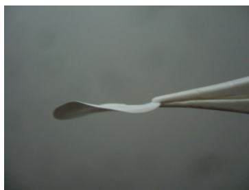
Figura 27: Filtro de acetato de celulose misto deformado devido ao uso de 2-propanol como solvente.
