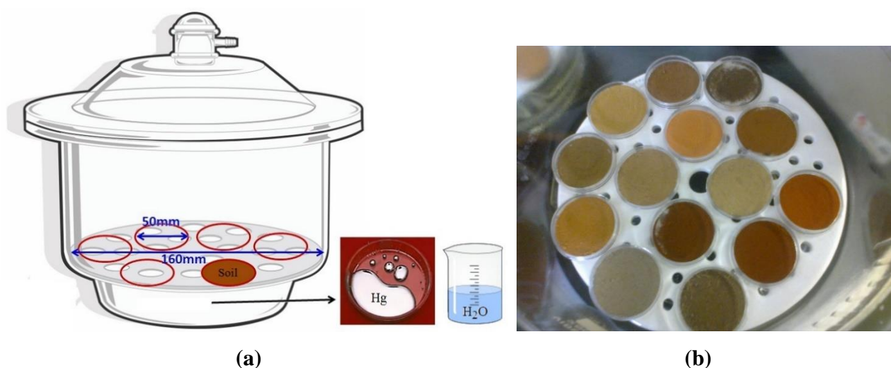
Figura 4.1. Experimento de incubação dos solos com vapor de mercúrio: (a) Esquema do dessecador com mercúrio, água e amostras. (b) Solos distribuídos no dessecador.
