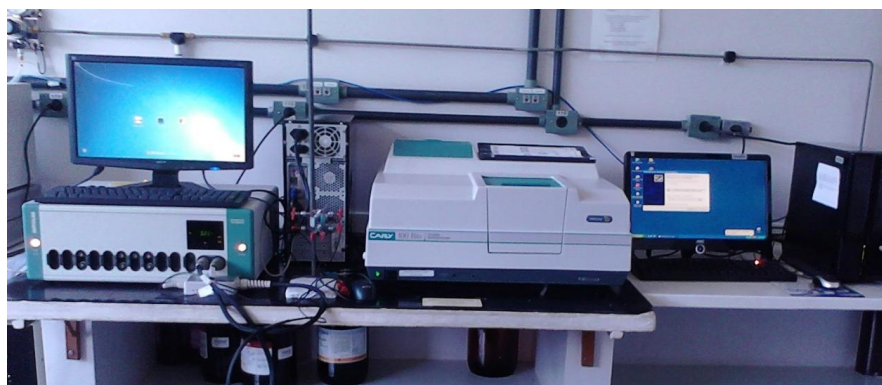
Figura 22: Esquema dos equipamentos utilizados nas medidas espectroeletrônicas.
