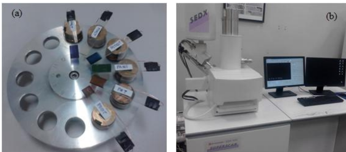
Figura 21: (a) Filmes obtidos sobre ITO posicionados no porta-amostra; (b) Equipamento utilizado nas análises MEV.
