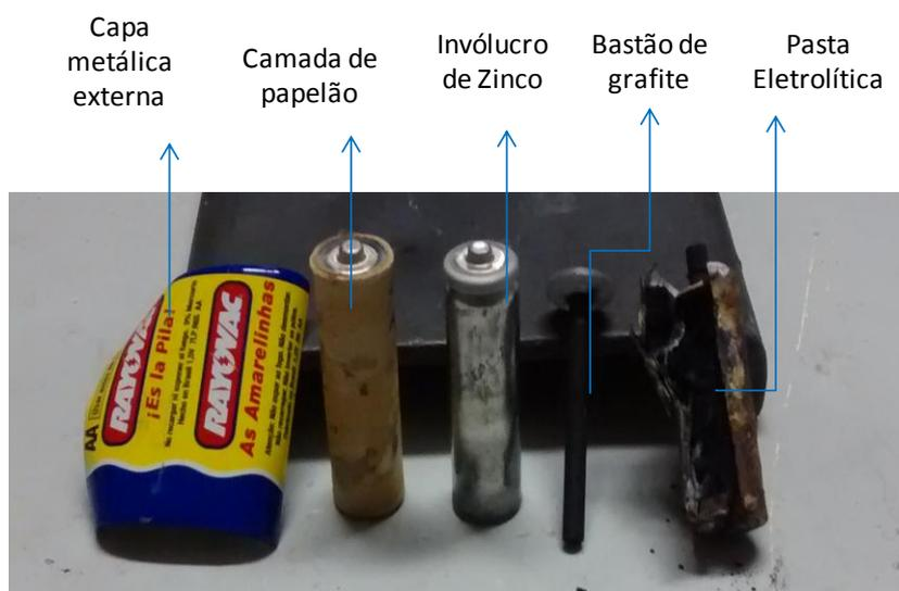
Figura 10: Foto das pilhas desmanteladas.
