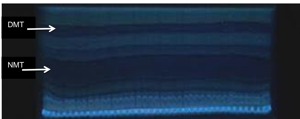
Figura 62: Foto da cromatoplaça obtida por CCD preparativa, da amostra AG60 a 64. Fase móvel \text{CHCl}_3/\text{MeOH} (97:3) em atmosfera de amônia; revelação luz UV.
