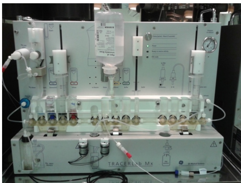
Figura 11 – Ilustração do módulo TracerLab MX FDG com cassete adaptado para síntese de 5'
