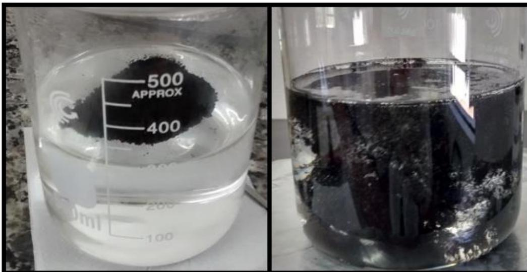
TABELA 6.1. a) adição dos CNTs ao polioli, b) suspensão obtida após mistura mecânica dos CNTs com polioli.
