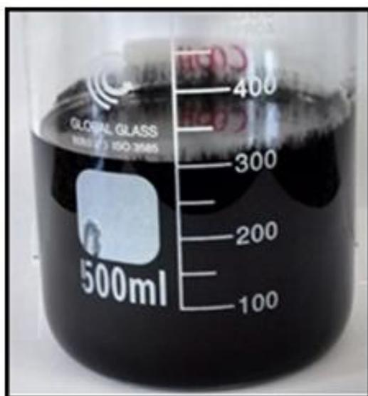
FIGURA: 6.3: Suspensão de CNTs em polioliol após processamento em moinho de rolos
