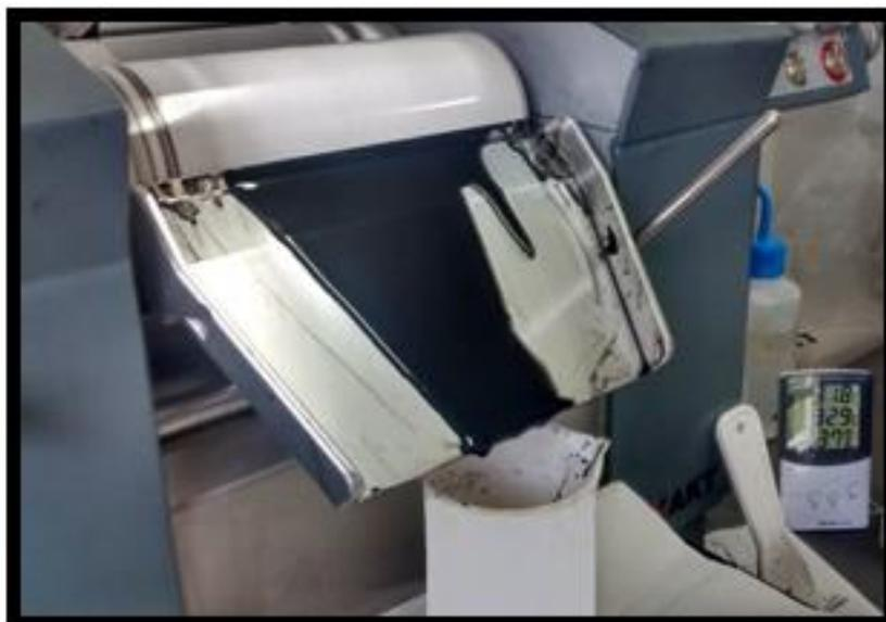
FIGURA: 6.2: Processamento da mistura polioli/CNT em moinho de rolos (LOPES et al., 2013).
