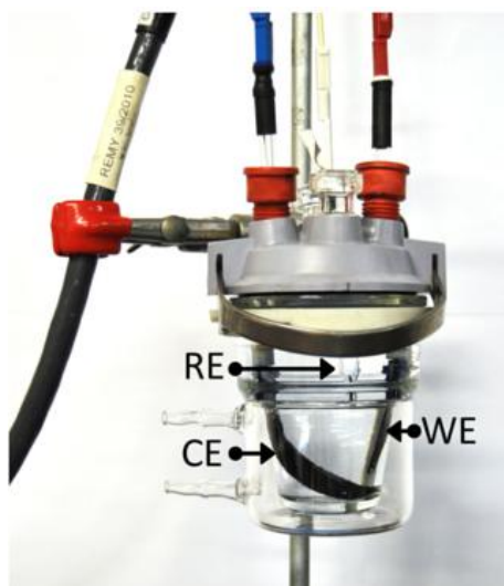
Figura 14. Célula eletroquímica utilizada nas reações de eletroinserção iônica, onde estão indicados os eletrodos de trabalho (WE), contra-eletrodo (CE) e referência (RE, Ag/AgCl, 5M NaCl).
