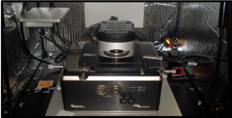
**FIGURA 2.6** - Microscópio de varredura por sonda MFP3D da Asylum Research® [6].
