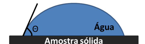
Figura 2.5 – Ilustração esquemática da medida do ângulo de contato.
