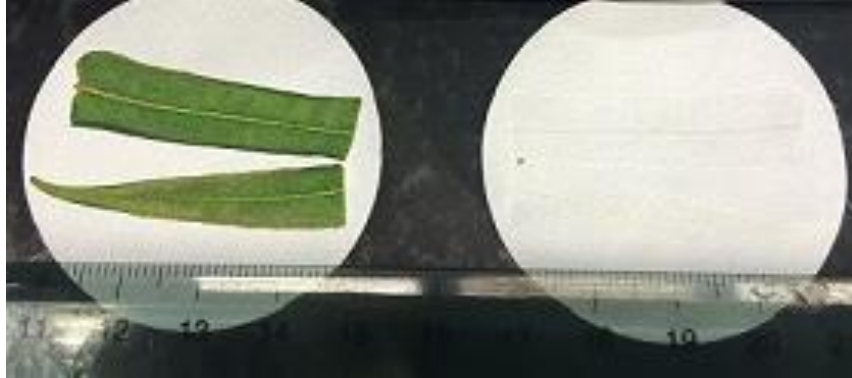
Figura 21. Imagem da folha de samambaia ( Pteris vittata ). Lado esquerdo: imagem ótica da folha preparada para a impressão. Lado direito: imagem ótica da impressão na superfície do filtro de PTFE.
