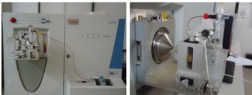
Figura 3. Vista frontal e lateral da fonte DESI acoplada ao espectrômetro de massas utilizados neste trabalho.
