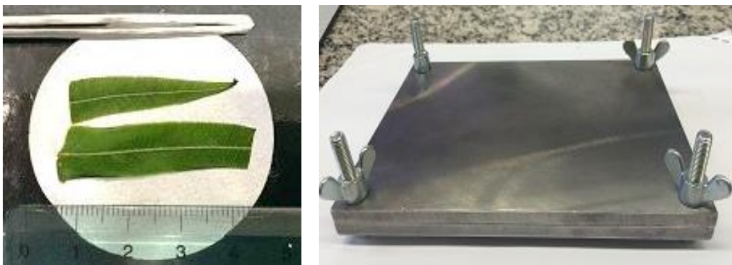
Figura 6. A) Imagem óptica da folha de samambaia preparada para a impressão no papel de filtro; B) Prensa utilizada no procedimento de impressão.
