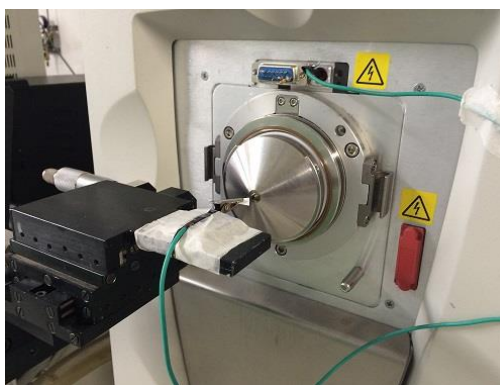
Figura 4. Vista frontal da fonte paper spray utilizada neste trabalho
