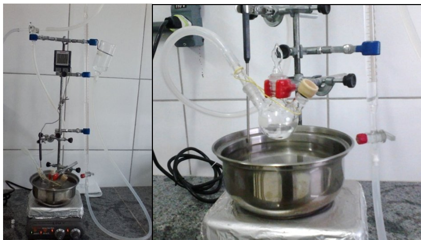
Figura 2.1. Fotografia da montagem padrão de uma reação em atmosfera de 1 atm de oxigênio.
