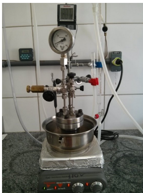
Figura 2.2. Fotografia da montagem padrão de uma reação realizada a pressão maior que 1 atm de oxigênio.
