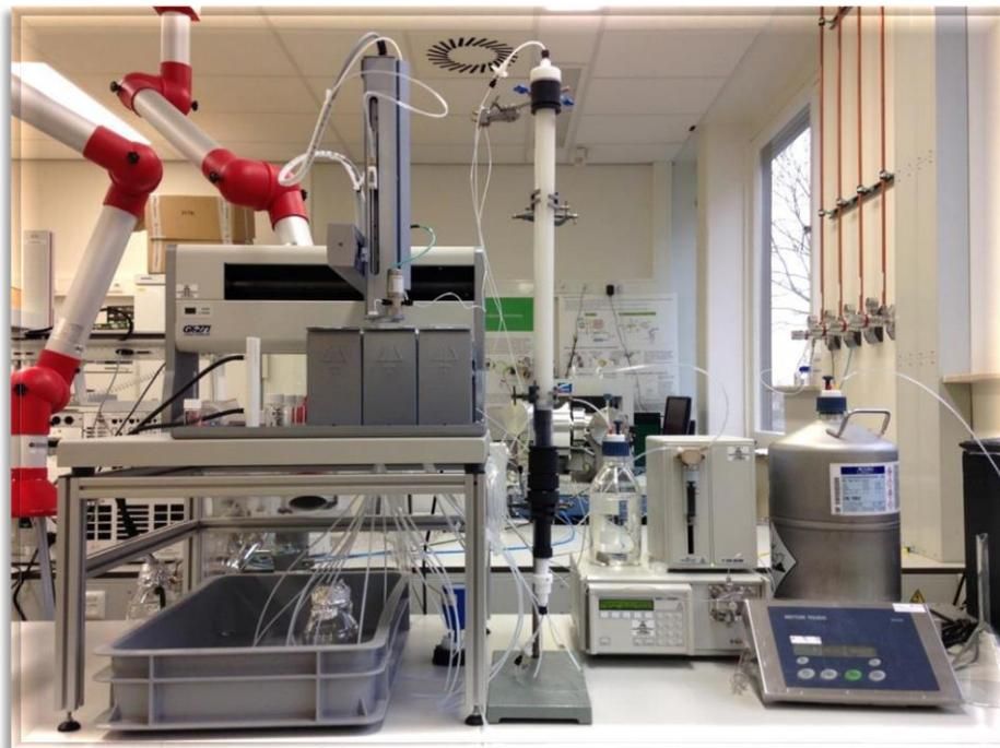
Figura A. 8: Equipamento PowerPrep utilizado na etapa de *clean-up* em todos os projetos.
