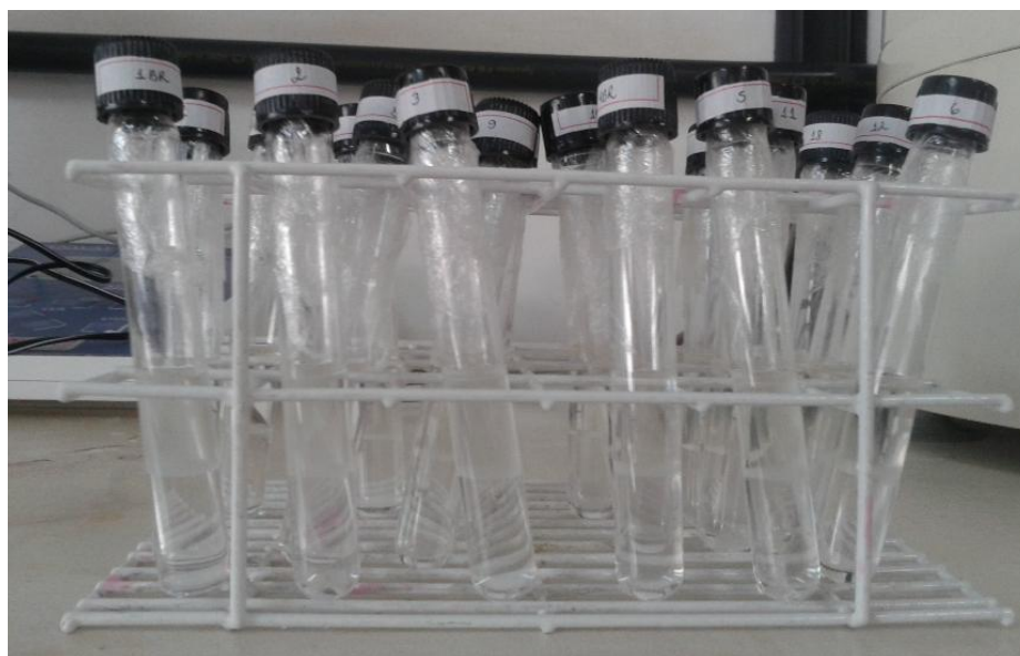
Figura 11. Ensaios de um experimento de SAB composto por L64 + Na 2 SO 4 + H 2 O, em pH = 6,00, no CLA igual a 41,83% m/m e utilizando APDC como extratante.
