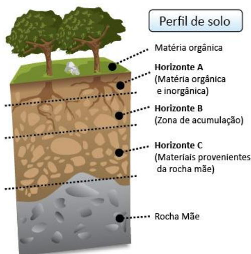
Figura 1.2. Esquema de um perfil de solo hipotético mostrando os principais horizontes. (Fonte: http://conectegeoblogspot.com.br/2010/11/perfil-de-solo.html )
