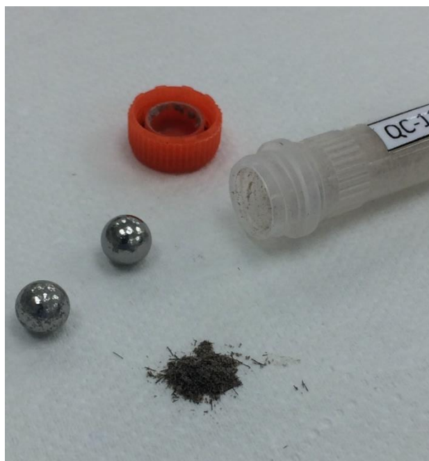
Figura 13. Imagem de amostra de cabelo após moagem. Ao lado estão as duas esferas de aço inox e o microtubo de 2,0 mL de polipropileno utilizados.
