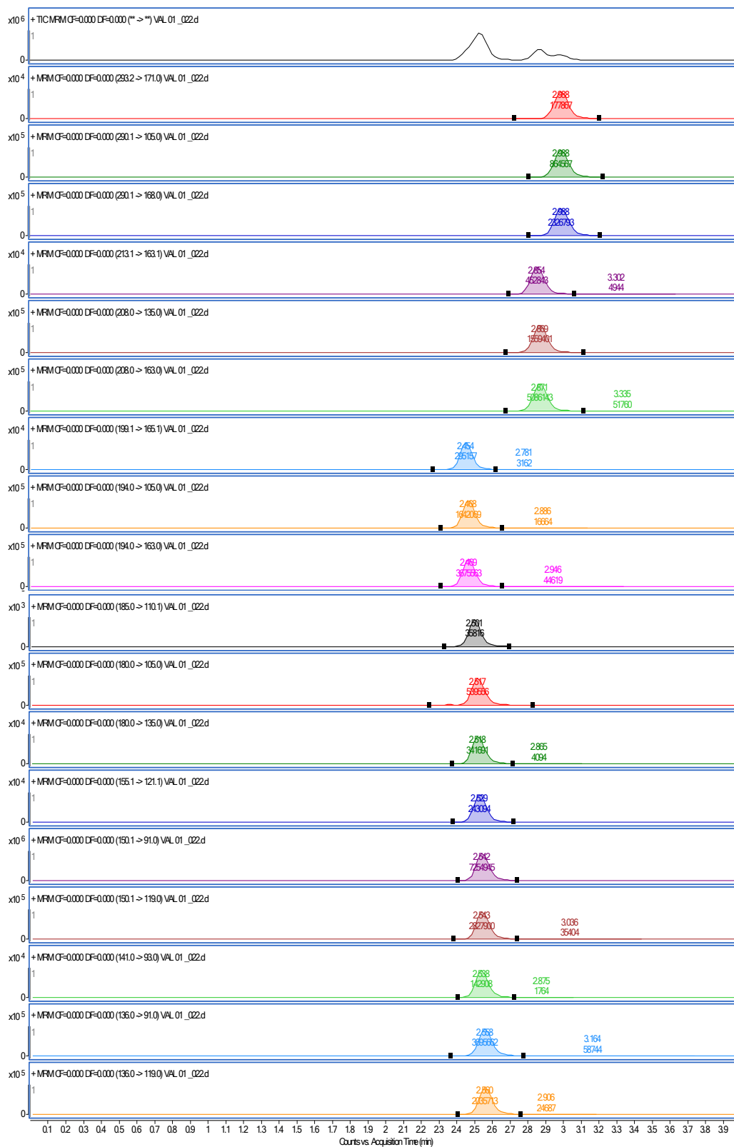
Figura 11. Cromatogramas de uma solução contaminada com concentração de 10,0 \text{ ng mL}^{-1} de cada analito. Estão representados os cromatogramas de todas as transições de massa monitoradas pelo método. O primeiro gráfico é referente ao cromatograma de íons totais (TIC).
