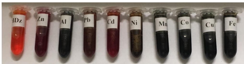
Figura 3-16. Solução polimérica contendo apenas ditizona (HDz) e a mesma solução adicionada dos metais Zn, Al, Pb, Cd, Ni, Mn, Co, Cu e Fe, respectivamente, em pH 12.
