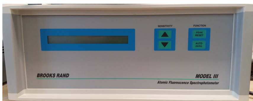
Figura 2.4: Módulo de detecção do sistema CG-pyro-AFS, Merx, Brooks Rand Labs.
