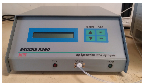
Figura 2.3: Módulo da CG e coluna pirolítica.
