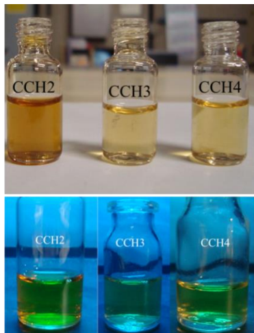
Figura 50: Dispersões aquosas das amostras CCH2, CCH3 e CCH4. Acima, sob iluminação natural e abaixo, expostas a radiação ultravioleta (365nm).
