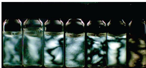
Figura 7: Dispersões de NCC obtidos via hidrólise com ácido sulfúrico, em concentrações de 5\text{mg.mL}^{-1} . Da esquerda para a direita: dispersão em água obtida diretamente do processo de hidrólise, material liofilizado e redisperso em água, dimetilformamida, DMSO, n-metilpirrolidona, ácido fórmico, m-cresol. Reproduzido da referência Habibi et al. (2010).
