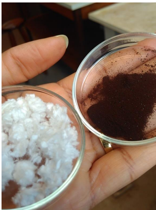
Figura 61: Imagens digitais das fibras de celulose (esquerda) eCDOTCEL seco (direita) por liofilização.
