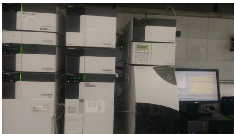
Figura 10: Cromatógrafo líquido modelo LC-20AT com detector UV-Vis SPD-M20A utilizado na obtenção dos valores de referência para as amostras.
