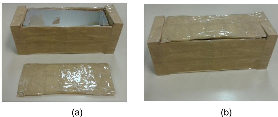
Figura 16. Imagem do molde utilizado na fabricação das espumas (a) aberto e (b) fechado.
