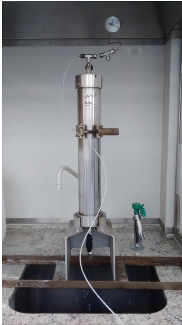
**Figura 12:** Garrafa inox utilizada no teste de cisalhamento mecânico.
