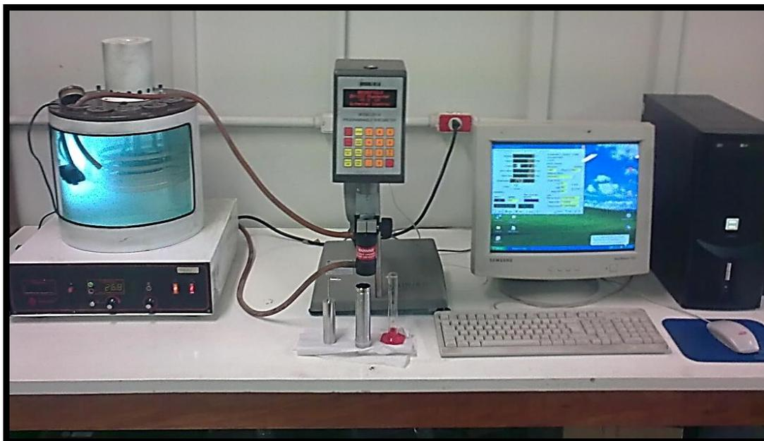
**Figura 11:** Fotografia do viscosímetro utilizado nas medidas de viscosidade.
