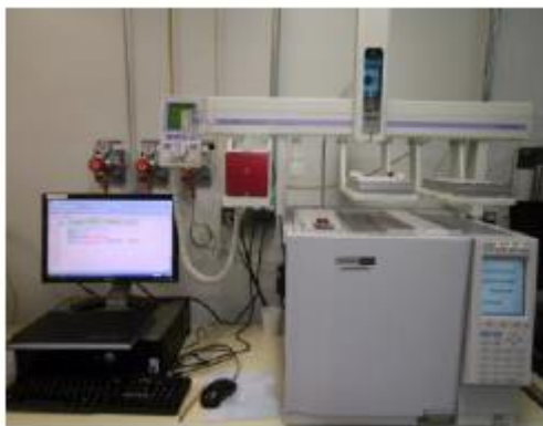
Figura 19- Cromatógrafo a gás da Shimadzu utilizado para determinação do teor de ésteres metílicos e etílicos [45].
