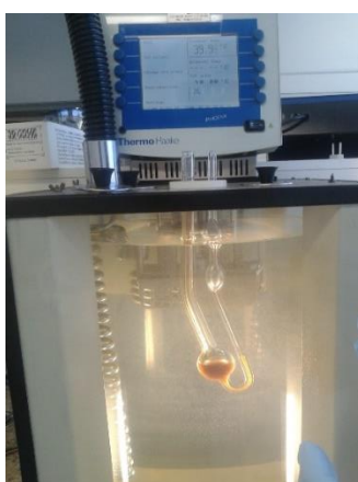
Figura 10- Banho de aquecimento e viscosímetro Cannon Fenske utilizados para a determinação da viscosidade cinemática.
