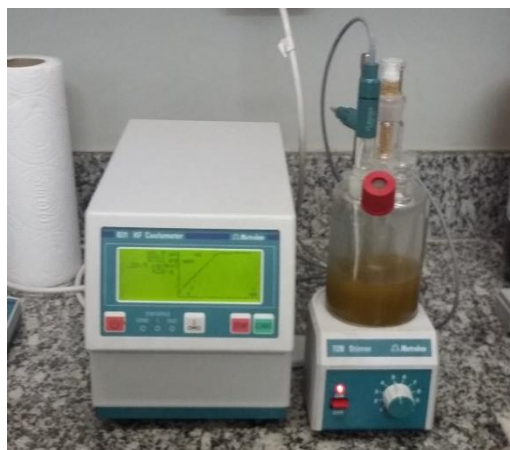
Figura 8- Equipamento utilizado para determinação do teor de água pelo método Karl Fischer, segundo ASTM D 6304.
