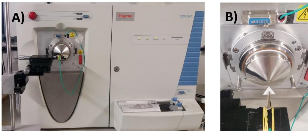
Figura 12. Aparato instrumental utilizado para as análises: a) Espectrômetro de massas Thermo LQC-Fleet; b) Fonte de ionização *paper spray*.
