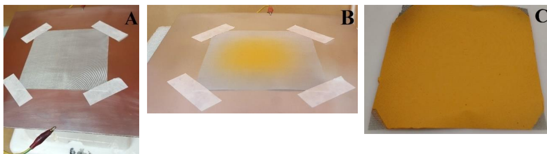
Figura 11. Sistema de fabricação das nanofibras (A) antes, (B) durante e (C) após a deposição das nanofibras em ambas faces da malha metálica.
