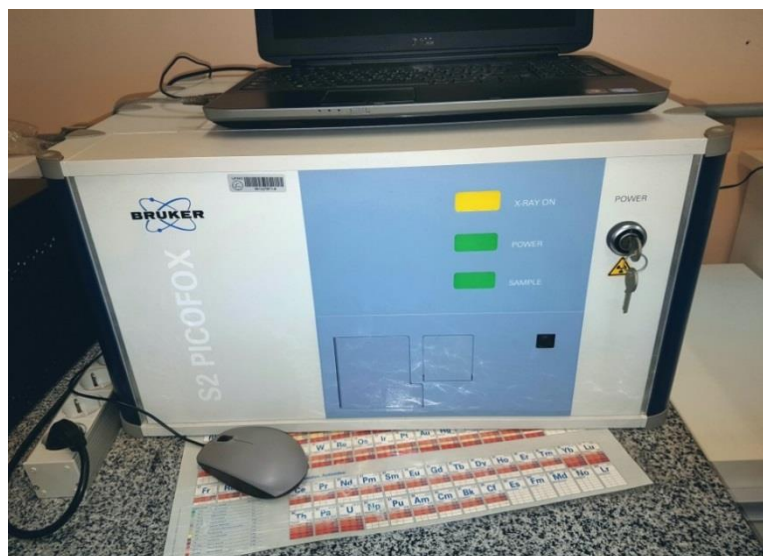
Fig.12 – Espectrômetro de fluorescência de raios-X por reflexão total. Fonte: a autora
