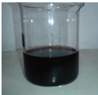
Figura 23. Efluente de indústria têxtil utilizado nos ensaios de remoção dos corantes.
