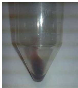
Figura 25. Decantado obtido a partir do efluente têxtil.
