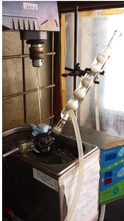
Figura 22. Montagem do sistema reacional para modificação química dos MWCNT.
