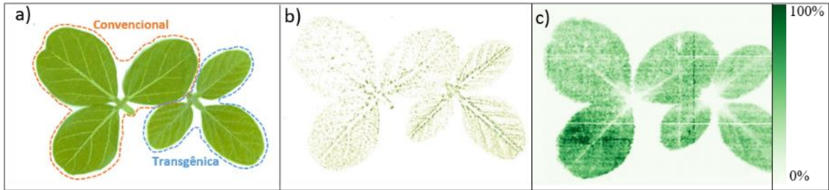
FIGURA 6.5 Imagens ópticas das folhas de soja transgênica e convencional (a.) e do imprint resultante (b). Distribuição espacial do metabólito trigonelina pelas folhas de soja (c).
