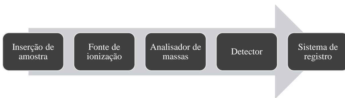
FIGURA 3.2 Principais componentes do espectrômetro de massas.
