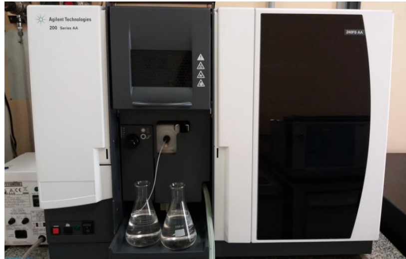
Figura 15: Espectrofotômetro de AA da marca Agilent, modelo 200. Fonte: Autor.
