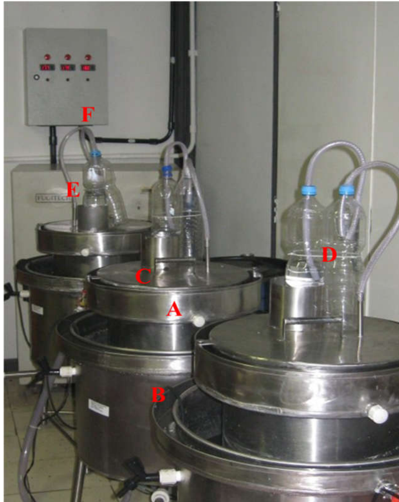
Figura 5. A - Biorreator; B - cilindro para banho d'água com controle automático de temperatura; C – tampa com lacre d'água; D – escape de gás; E – refrigerador e F – central de automatização do sistema de controle de temperatura
