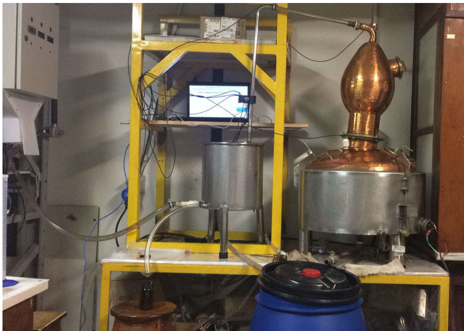
Figura 9. Alambique conectado ao computador com o sistema embarcado
