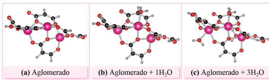
**Figura H.3.** Aglomerados metálicos para simulação da rede metalorgânica  $Mg_2DOBDC$  no processo de adsorção de água neste material. Aglomerado metálico com três cátions de  $Mg(II)$  coordenativamente insaturados (a) e adsorção de uma (b) ou três (c) moléculas de água neste modelo. Legenda de átomos: oxigênio (vermelho), carbono (preto), magnésio (rosa) e hidrogênio (cinza).
