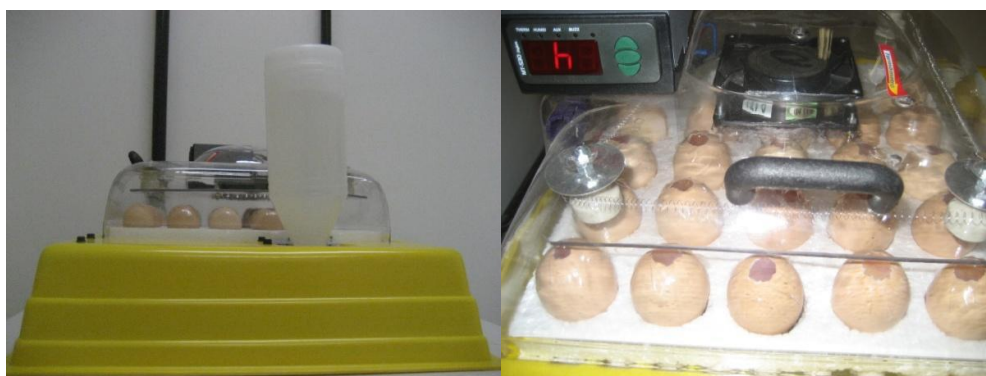
Figura 36 – Incubadora automática utilizada nos ensaios HET-CAM
