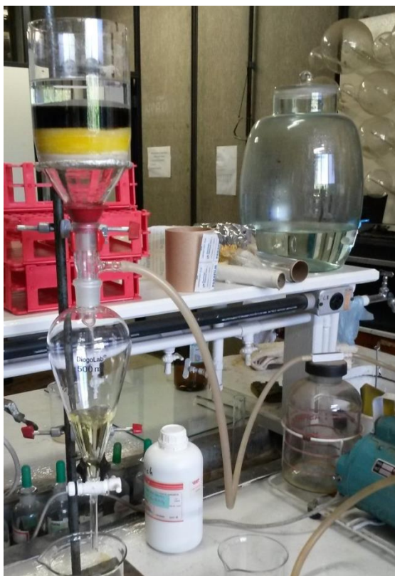
Figura 17 – Montagem da dry column vacuum chromatography
