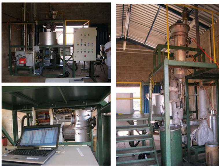
Figura 2.3. Planta piloto de pirólise rápida localizada na UFU, Campus do Pontal, Ituiutaba, MG.
