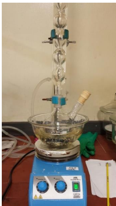
Figura 2.1. Esquema de sistema em refluxo utilizado nas lixiviações dos resíduos de baterias NiMH.
