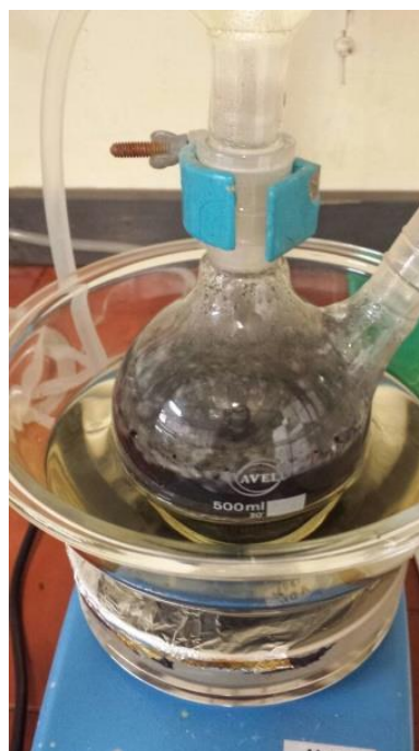
Figura 2.1. Esquema de sistema em refluxo utilizado nas lixiviações dos resíduos de baterias NiMH.
