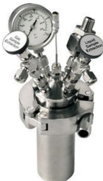
Figura 3.3: Foto da autoclave utilizada como reator em batelada.
