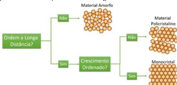
Figura 2.1 – Esquema de classificação ilustrado de materiais amorfos, policristalinos e monocristalino.
