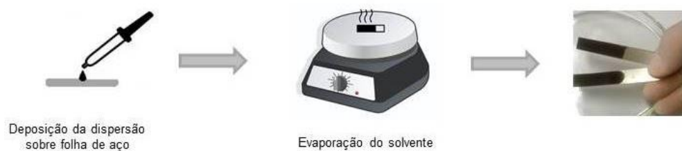
Figura 18: Representação esquemática do preparo de eletrodos via casting .
