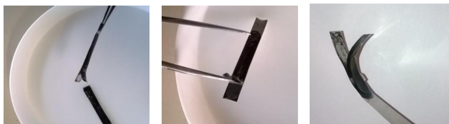
Figura 66: Conjunto eletrodos contendo eletrólito tipo 3 (SC3) depositados sobre folhas de aço após período de armazenagem de 31 dias.
