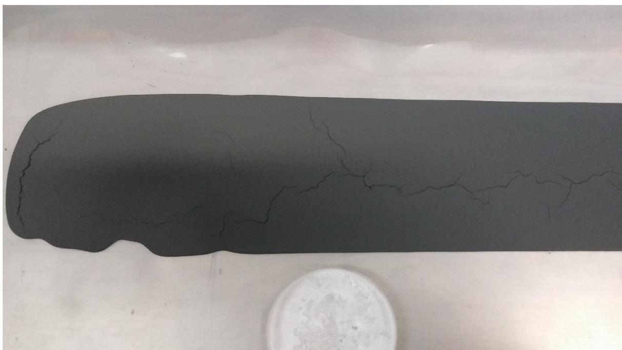
**Figura 24** - Imagem da fita obtida após a secagem.
