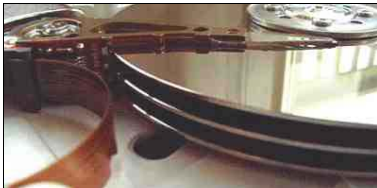
Figura 5.3: Aspecto interno de um disco rígido, evidenciando os múltiplos discos e a cabeça de leitura/gravação da superfície superior. Há outras 5 cabeças de leitura/gravação, não visíveis nesta imagem. Fonte — BRAIN.03a
