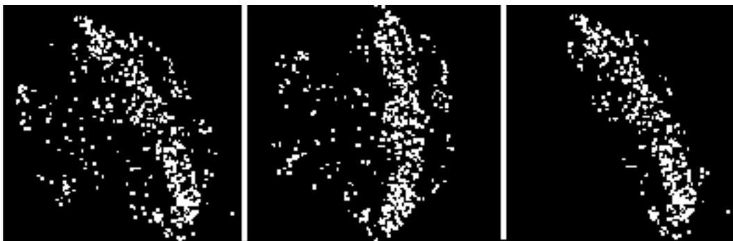
Figura 5.10: Estágios do PCA: pontos recebidos, rotação no novo eixo e corte por limiar (com rotação de volta para o eixo original).
