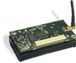
Figura 2.2: Plataforma de nó sensor MicaZ.
