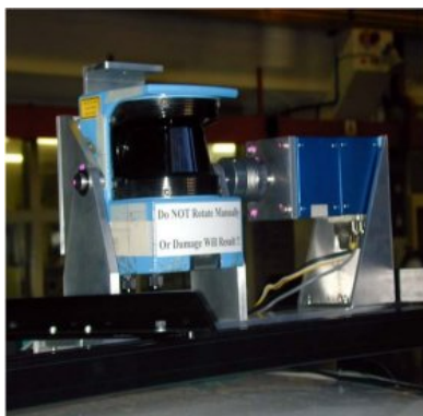
Figura 2.3. Laser sobre plataforma giratória [Katz et al., 2006].
