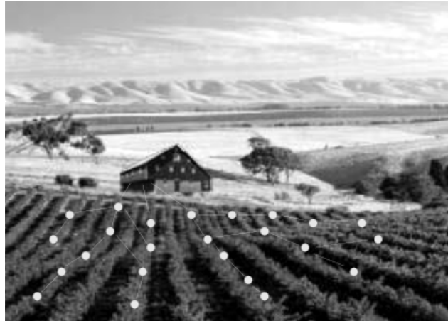
Figura 2.1: Possível disposição de uma RSSF para a agricultura. Sensores detectam temperatura, luz e umidade do solo em centenas de pontos distribuídos em uma plantação e se comunicam através de uma rede multi-saltos.
