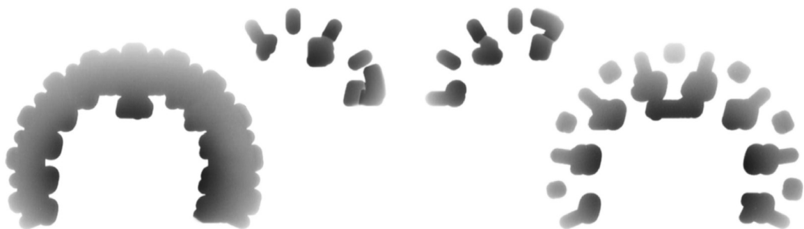
Figura 2.6: Um exemplo de difusor aplicado sob a serigrafia.
