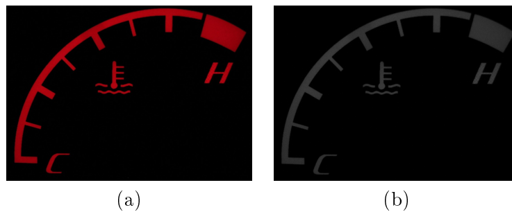
Figura 4.4: Conversão do espaço de cores: (a) Figura original; (b) Canal V, do espaço HSV, correspondente à imagem de (a).
