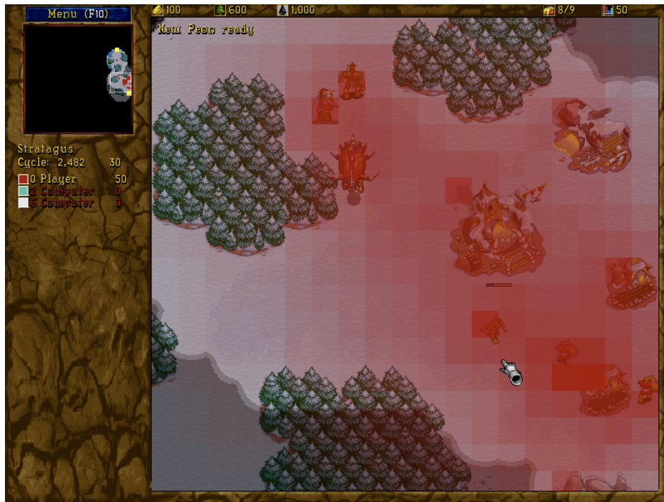
Figura 2.7. Renderização de depuração de um mapa de influência de raio limitado gerado para um pequeno exército. A intensidade da influência das unidades é representada por quadrados vermelhos de opacidade variável. Quanto mais opacos, maior a influência naquela célula.
