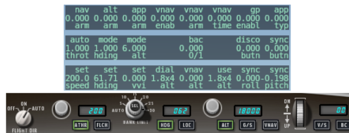
Figura 5.7. Piloto automático do avião Cirrus Jet mantendo velocidade de 200 knots, altitude de 18.000 ft e direção de 62 graus.
