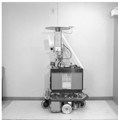
Figura 2.2. O robô Shakey, primeiro robô móvel com capacidade de planejar as suas tarefas.
