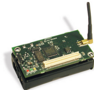
Figura A.2. Foto nó sensor micaZ, compatível com a tecnologia 802.15.4/Zigbee, que foi utilizado como beacon neste trabalho.
