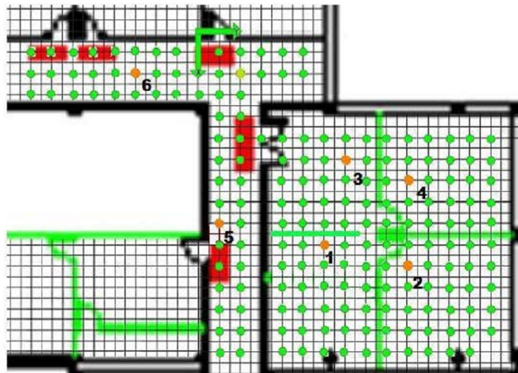
Figura 2.15. Pontos de treinamento e pontos nos quais ocorreram testes em [Aparicio et al., 2008a]. (Melhor visualizado em cores).
