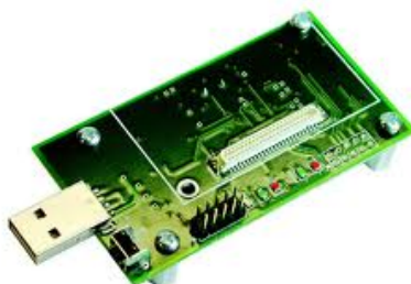
Figura A.7. Placa de programação MIB 520 utilizada.
