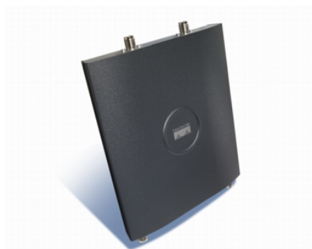
Figura A.4. Outro modelo de ponto de acesso Cisco, o AIR-AP1242AG-A-K9. Também foi utilizado como beacon .
