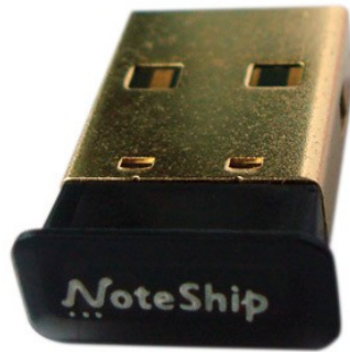
Figura A.1. Foto do adaptador USB, compatível com a tecnologia Bluetooth, que foi utilizado como beacon neste trabalho.
