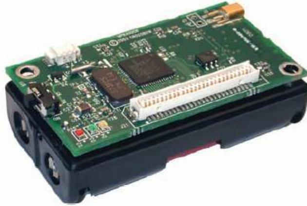
**Figura 2.1.** Modelo de nó sensor Mica2 da linha Motes [mic, 2011]
