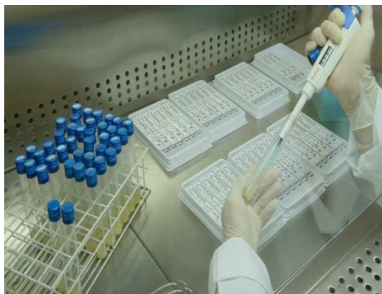
Figura 4. Distribuição das amostras nas barretas para realização das análises pelo método ELFA.
